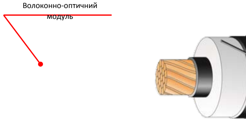
Мал. 4. Конструкція кабелю з волоконно-оптичним модулем.
