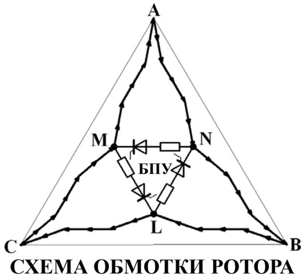
СХЕМА ОБМОТКИ РОТОРА
